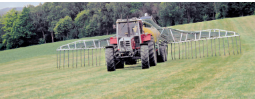
Mehr als 2,15 Mio. \text{m}^3 Gülle, Jauche und Biogasgülle werden in Österreich jährlich bereits mit bodennaher Technik ausgebracht. Foto: E.M. Pötsch
