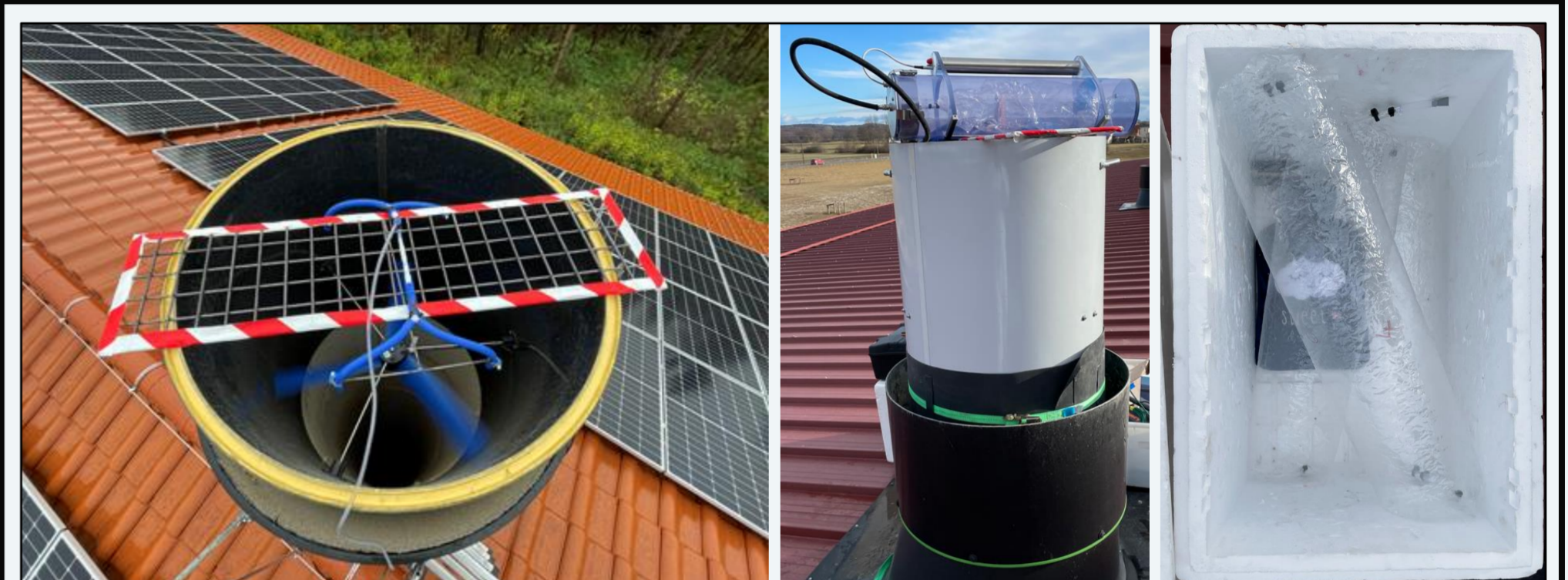
Abb. 3: Probenahme Geflügelbetrieb; Messkamin mit Vorrichtung zur Geruchsprobenziehung und Messventilator, Messkamin und Probensammler CSD 30 & gefüllte Nalophansäcke in Isolierbox
