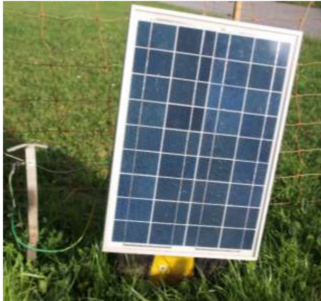
Starkes Solargerät- schwache Erdung
