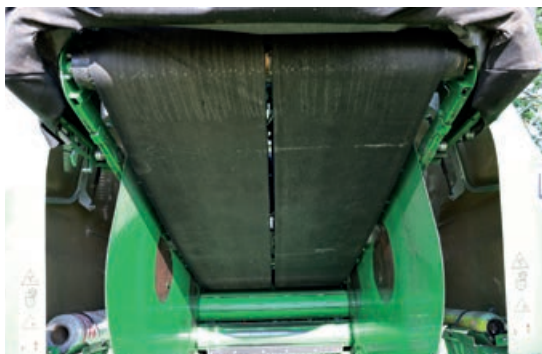
Nur zwei Gurte, zwei bewegliche Seitenplatten und drei Walzen bilden die Presskammer.
