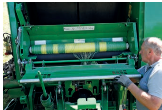
Verunreinigungen beim letzten Schnitt können die Netzbindung stören.
