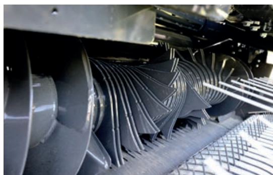
Der Integralrotor „frisst“ gut, lediglich die Überlastsicherung war sanft eingestellt.
