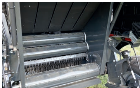
Die mit Druck schließende Presskammer besteht aus fünf Riemen und drei Walzen.
