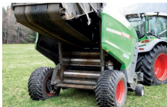
Die vier Pressriemen werden über zwei groß dimensionierte Rollen angetrieben.
