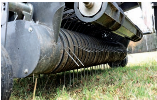
Die pendelnde Pick-up passt sich Bodenunebenheiten gut an und nimmt das Futter sauber auf.
