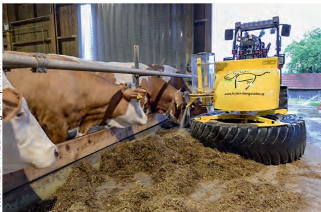
◁ Nachschieben des vorgelegten Futters erhöht die Grundfutteraufnahme der Tiere. Im Bild eine findige Entwicklung, die das Anschieben mit einer Lockfütterung kombiniert.
