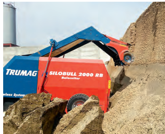
△ Ein Futterentnahmewagen mit Fräse kann Futter aus hohen Stöcken entnehmen.
