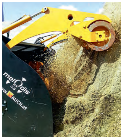
△ Eine Futterverteilschaufel mischt das Futter gar nicht oder nur teilweise.
