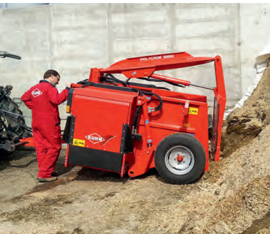
△ Behälter mit Silokamm sind zwar robust, bieten allerdings keinen glatten Schnitt.
