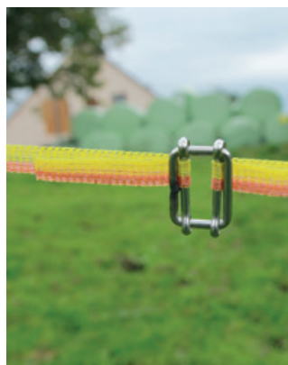
Gute Stromübertragung durch Band- und Litzenverbinder.
