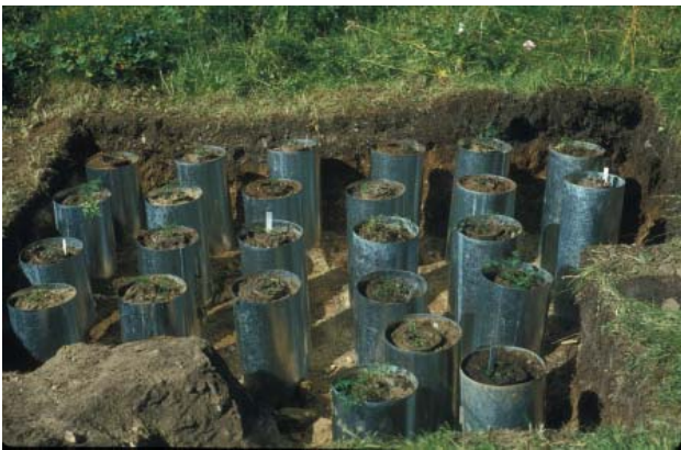
Abbildung 1: Im Boden versenkte Versuchsröhren, die Leerräume zwischen den Röhren wurden wieder mit der ausgehobenen Erde ausgefüllt und über die Vegetationszeit von Unkraut freigehalten.
