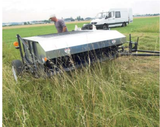
Abbildung 2: Bürstgerät bei der Gewinnung von Saatgut einer Glatthaferwiese
