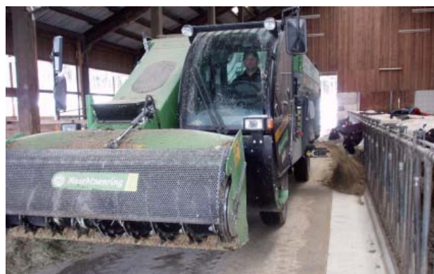
Mittels einem Querförderband wird den Tieren das Futter gleichmäßig vorgelegt
