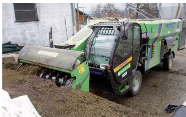
Der Futtermischwagen während des Abfräsvorgangs
