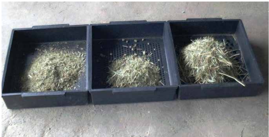
Abbildung 1: Penn State Particle Separator („Schüttelbox“) mit 2 Sieben und Wanne
