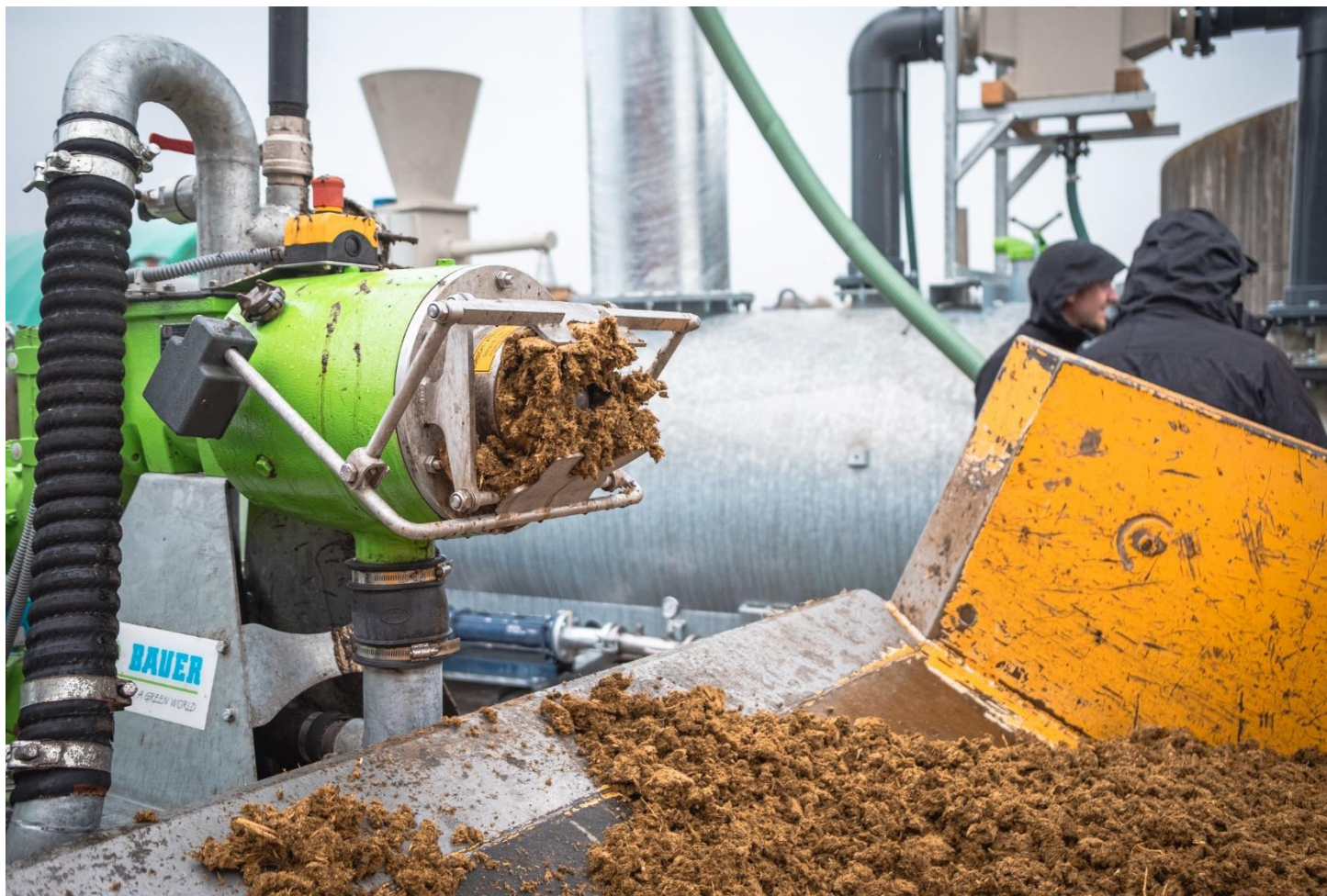
Schneckenpresse „Plug and Play“ der Bauer GmbH: © LK Steiermark, P. Zenger
