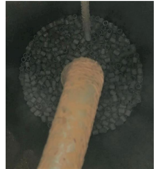
Einzelner Raschigring und Raschigring-Schüttung in der Strippeinheit: © TU Graz, P. Letonja
