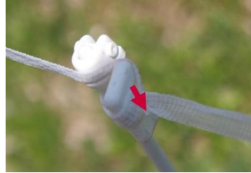
Falsche Montage - Litzen brennen durch
