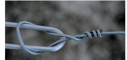
zu Geringe Fläche der Stromübertragung
