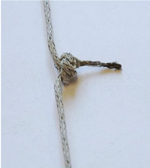
Geknüpfte Litzen – nur Stromleiter verdrehen
