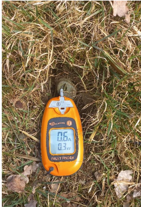
Am Erdungsstab max. 0,3 KV
