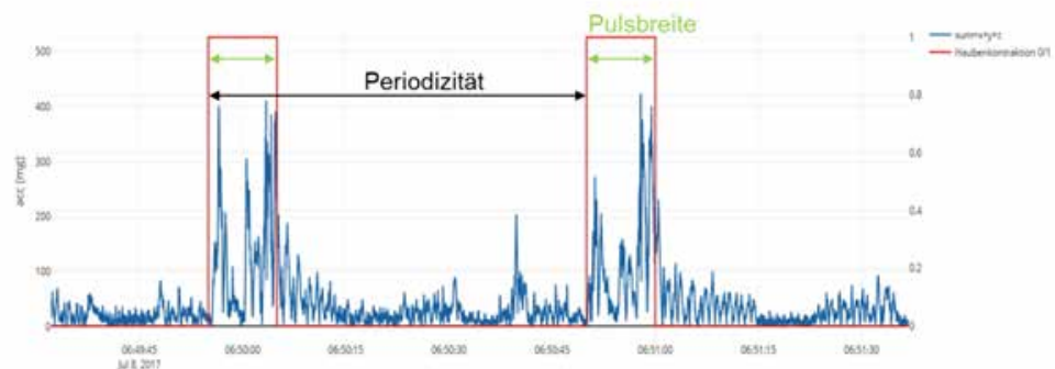
Abbildung 2 : Zeitlicher Verlauf der Haubenaktivität (milli-g). Mit der Kontraktionsdauer der Haube (Pulsbreite) und der Dauer zwischen zwei Kontraktions-Zyklen (Periodizität) ist es möglich, die Motility zu beschreiben. Sie liefert wertvolle Informationen über den Gesundheitszustand und kann auch zur Brunsterkennung herangezogen werden. Im einfachsten Fall wird aus dieser Messung im Pansen die Wiederkaudauer abgeleitet. Erste Vergleichsmessungen mit Verfahren wie der Videobeobachtung lassen vielversprechende Ergebnisse erwarten.
