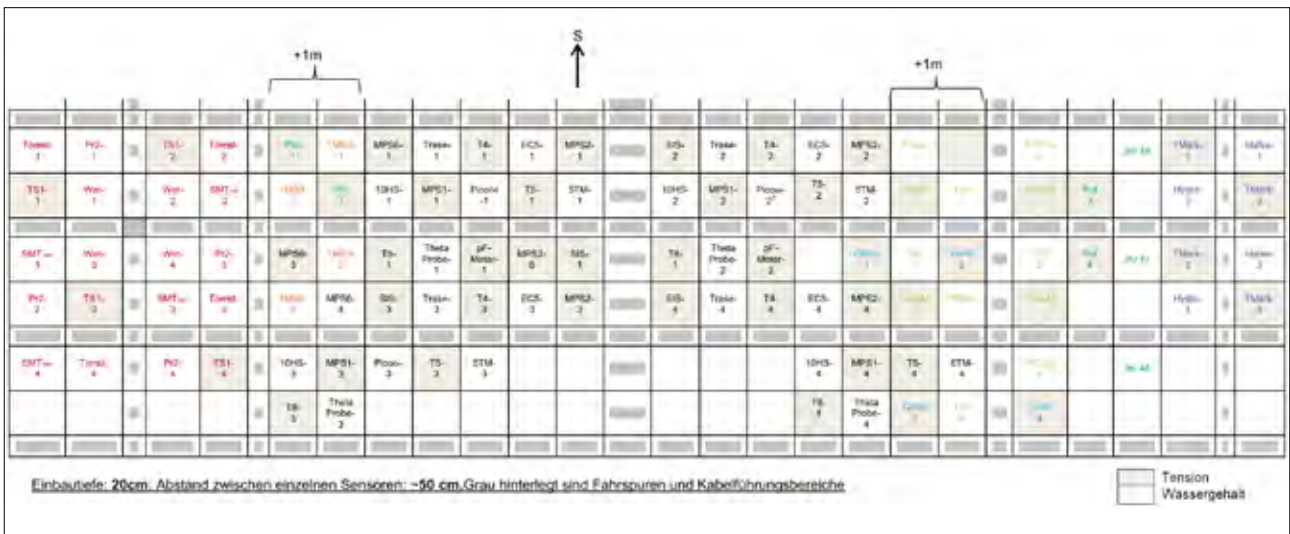
Abbildung 2: Anordnung der unterschiedlichen Sensoren (Aufsicht).
