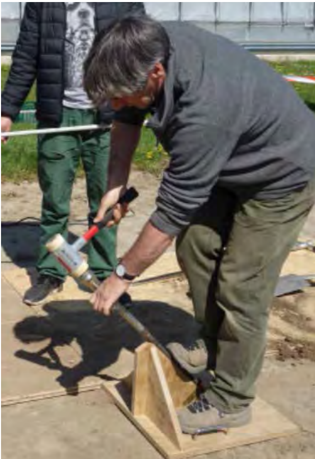
Abbildung 3: Für schräg eingebaute Messgeräte wurden mittels einer am Institut gebauten Apparatur Löcher in den Boden getrieben. Der Durchmesser der Bohrlöcher war variabel.
