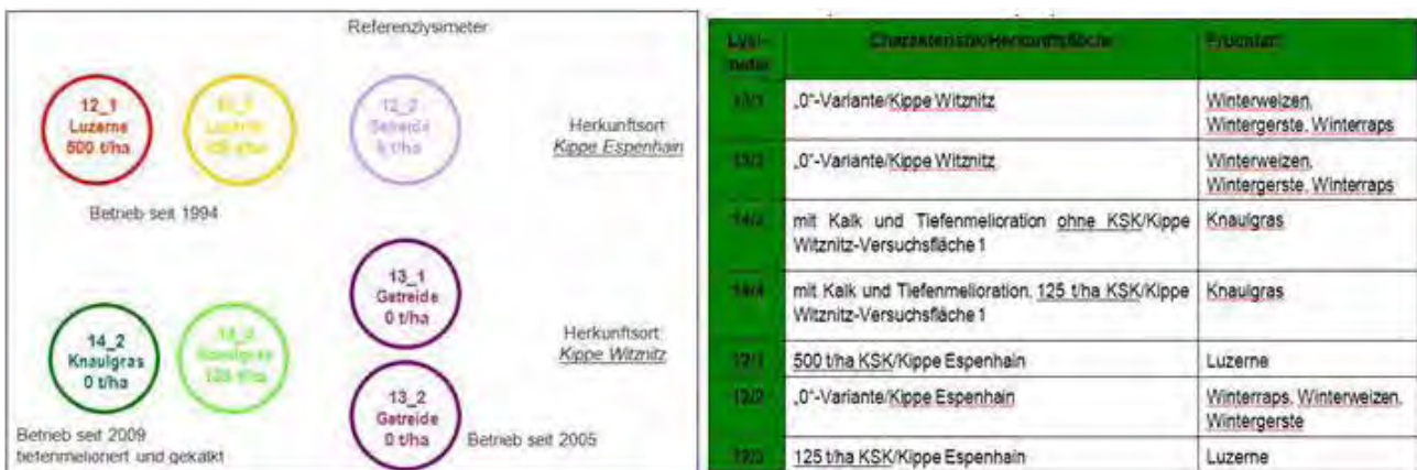
Abbildung 6: Versuchsanordnung der Lysimeter und realisierte Varianten (KSK – Klärschlammkompost) von 2008 bis 2011 (GFI GmbH, 31.01.2012).
