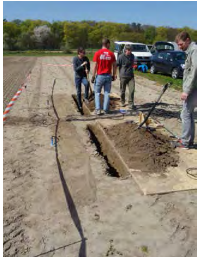
Abbildung 4: Für horizontal eingebaute Messgeräte wurde von den Außenseiten in Richtung Mitte des Versuchsfeldes ein spatenbreiter Graben gezogen. Nach Einbau der Sensoren wurde dieser wiederverfüllt.
