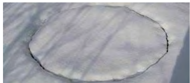
Abbildung 4: Lysimeteroberfläche nach erfolgter Trennung der Schneeauflast.
