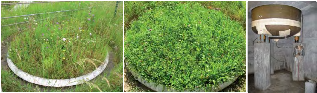
Abbildung 1: Lysimeter mit extensiv genutzter Wiese (links) und intensiv genutzter Wiese (Mitte) sowie Lysimeterkeller mit Kippwaage für die Sickerwassermessung (rechts).
