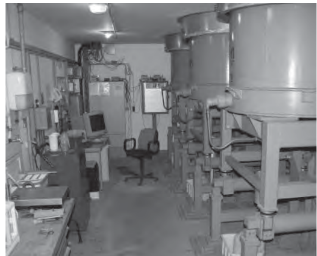
Abbildung 1: Lysimeterkeller der BfG - Lysimeterstation Niederwerth mit drei der vier wägbaren Lysimeterbehältern
