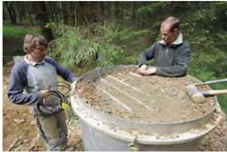
Abbildung 5: Einbau des Saugstangenrechens in ein Lysimeter (links), Schemazeichnung eines Lysimeters mit steuerbarer unterer Randbedingung (rechts).
