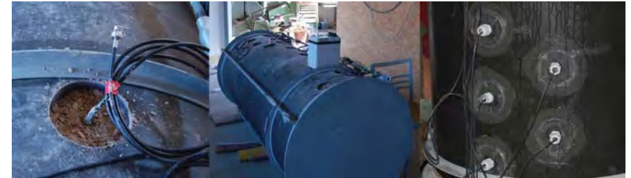
Abbildung 6: Abschluss der TDR-Sonden Installation
