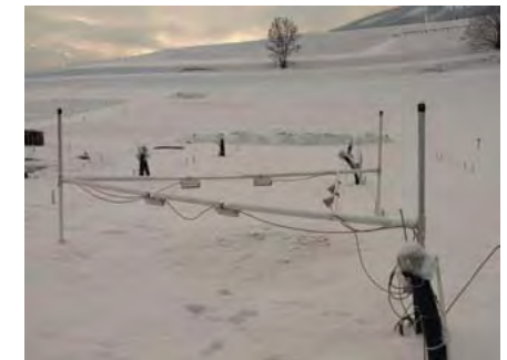
Abbildung 2b: Anordnung der Infrarotstrahler auf einem höhenverstellbaren Alugestänge im Versuchsgelände des technischen Versuchskonzeptes „Lysi-T-FACE“
