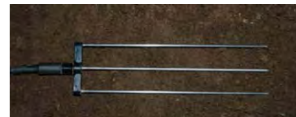
Abbildung 1: TDR-Sonde Buriable Waveguide 20 cm
