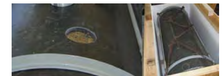
Abbildung 2: Tiefgefrorener Zylinder mit Einbaulöchern
