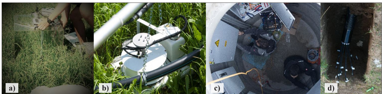
Abbildung 1: a) transparente Kammer zur Messung ökosystemarer CO 2 -Flüsse; b) automatische Bodenatmungskammer; c-d) Messschacht und Membranschläuche für CO 2 -Profil Messungen.
