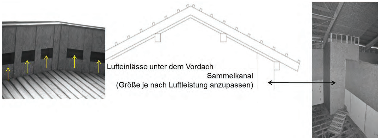
Abbildung 3: Schema einer Unterdachabsaugung bei Pfettendächern
