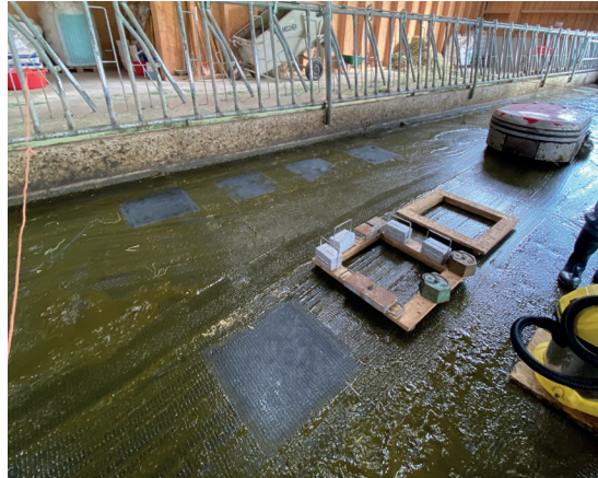
Abbildung 3: Methode der Erhebung der Restverschmutzung: Rahmen mit Gewichten begrenzen die Versuchsfläche (links) und Waage mit Nasssauger (rechts). Fotos: © Pitzen, Agroscope (2022).
