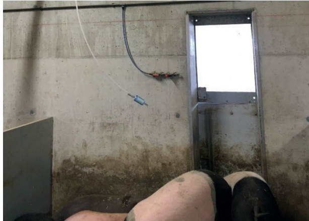
Abb. 3 und Abb. 4: Gasmessleitungen mit aufgesetzten Staubfiltern im Ruhebereich (Stallinnenraum) und im Kotbereich (Außenklima)
