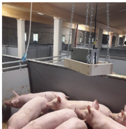
Abb. 7: Spectrometer 11-C mit radialer Probenahmesonde
