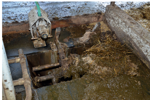
Abbildung 5: Abwurf und Ladeposition des Entmistungsroboters auf vier Praxisbetrieben. Zwei Praxisbetriebe mit mangelndem Schutz (links) und zwei Praxisbetriebe mit gutem Schutz (rechts). Fotos: © Pitzen, Agroscope (2021).
