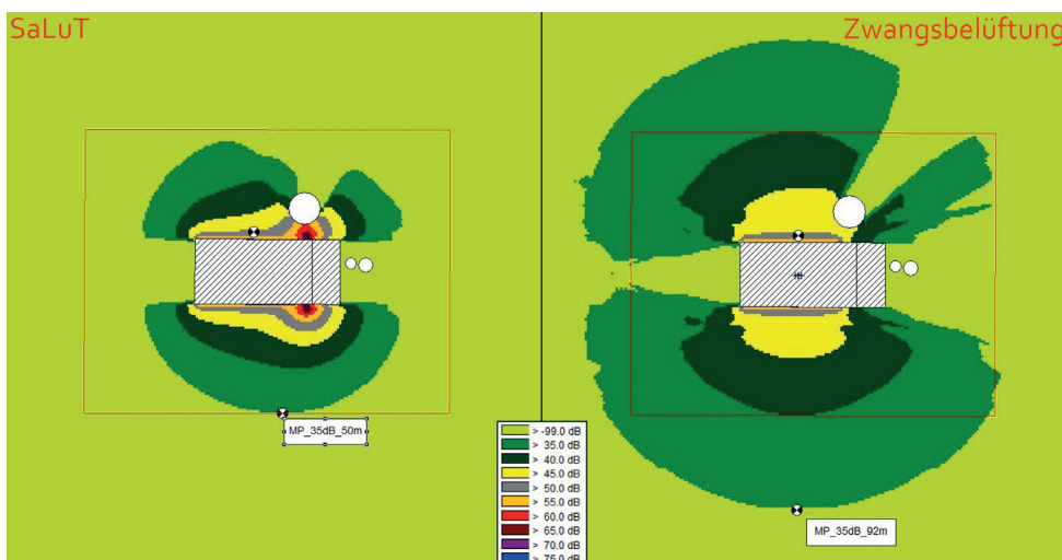
Abb. 26: Flächenhafte Schallimmissionsberechnung des SaLu_T-Stalles im Vergleich mit einem zwangsbelüfteten Stall
