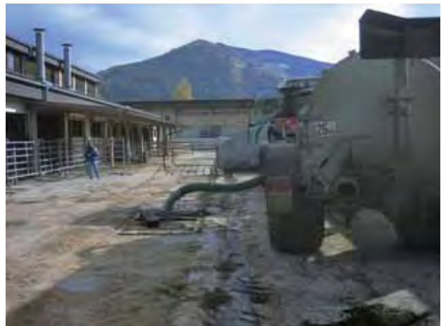
Abbildung 4: Schalltechnische Emissionserhebung einer Gülle-fassbefüllung (Mikrofon im Hintergrund)
