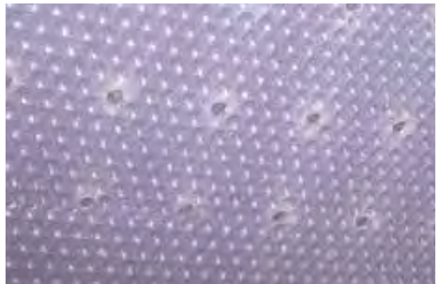
Abbildung 6: Doppellagige Kunststofffolie als Zuluftelement
