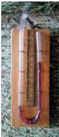
Bild 17: einfache Druckmessung mit 8 mm PVC-Schlauch. Im Bild wird knapp 90 mm Wassersäule entsprechend rund 900 Pa gemessen.
