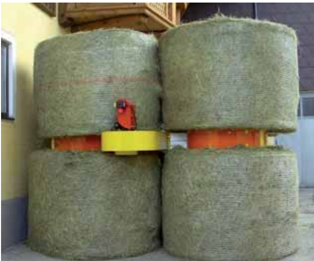
Bild 10: Kompaktanlage für 8 Ballen mit Zwischenringen (Foto MRH-Rieser)
