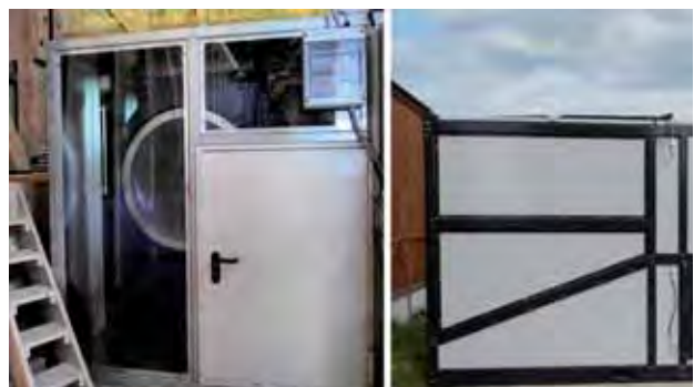
Bild 7: Links Kompaktentfeuchter mit Lüfter, rechts Warmluftofen
