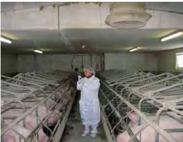
Abbildung 7: Messung des Innenpegels ( L_{A,eq} ) in einem Zuchtsauenstall
