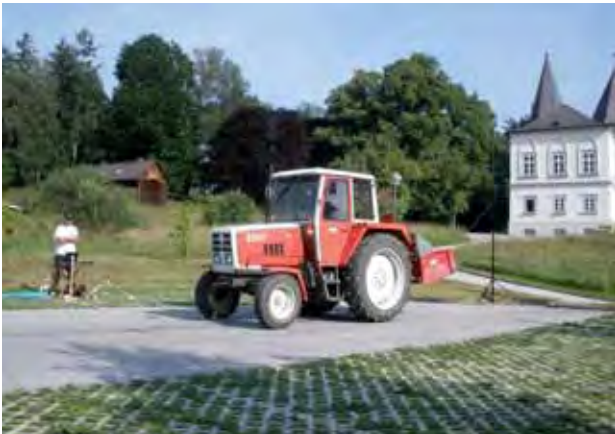
Abbildung 1: Schalltechnische Emissionserhebung eines Arbeitsvorganges (Mikrofon in rechter mittlerer Bildhälfte)
