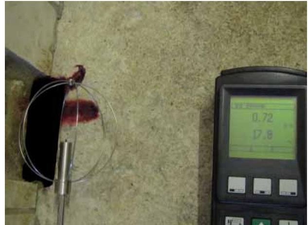
Abbildung 6: Zuluftgeschwindigkeiten bis zu 1m/sec
