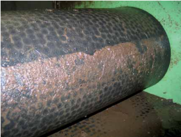
Abbildung 11: Nur geringe Schmutzablagerungen zwischen Matten und Lochspaltenelementen
