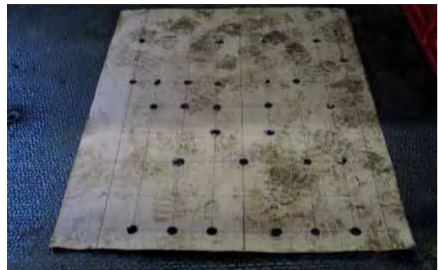
Abbildung 9: Mittels Schablone wird die exakte Ausrichtung der Löcher sichergestellt
