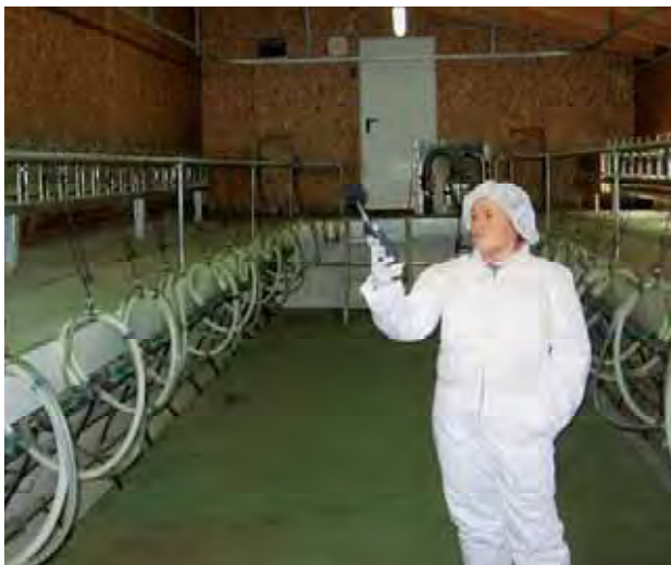
Abbildung 6: Messung des Innenpegels in einem Melkabschnitt während aktiver Melkanlage
