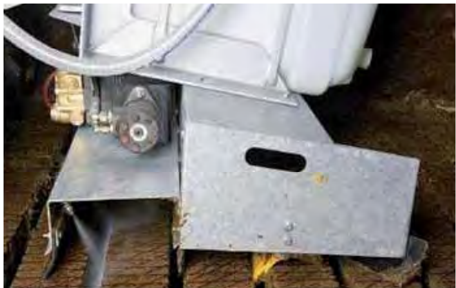
Abbildung 1: Wirkungweise des Spaltenreinigungssystems bestehend aus den drei Elementen Hochdruckreinigungsdüsen, Räumstern (Zwischenspalt) und Gummischieber.
