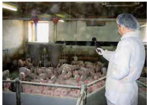
Abbildung 5: Messung des Innenpegels in einem Ferkelstall
