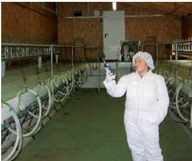
**Abbildung 6: Messung des Innenpegels in einem Melkabschnitt während aktiver Melkanlage**
