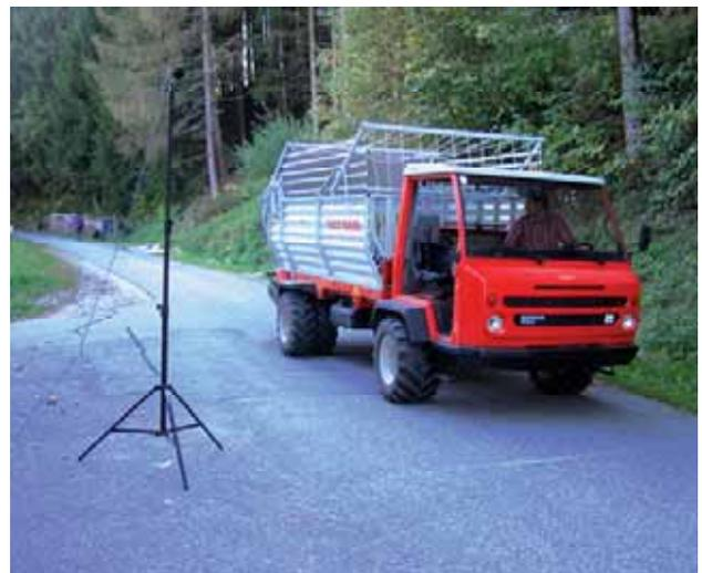
**Abbildung 7: Arbeitsmessung eines landwirtschaftlichen Transportfahrzeuges**
