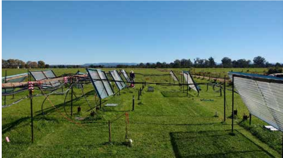
Abbildung 1: Versuchsanordnung auf einem Milchviehbetrieb in Casino, Northern New South Wales, Australien, mit einer vollautomatisierten Bewässerungsanlage, pneumatischen Treibhausgas Messkammern, Bodenfeuchtesensoren und schwenkbaren Dächern.
