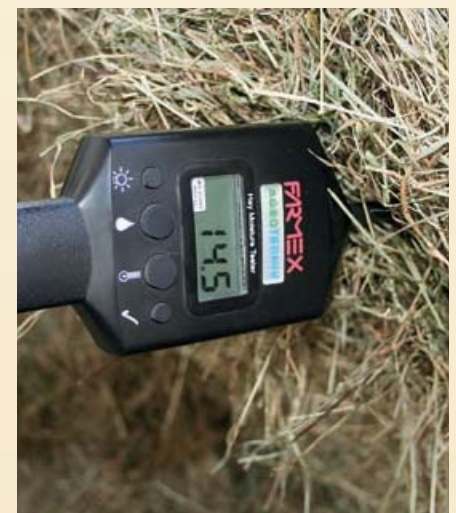
Mit einer Sonde können Temperatur und Feuchtigkeit genau gemessen werden.
