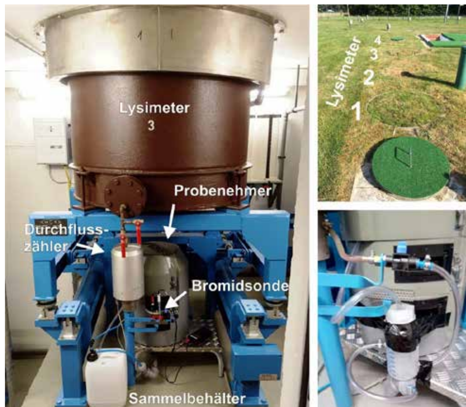
Abbildung 1: links: Lysimeter mit Einrichtung zur Probenahme und Bromidmessung im Durchfluss; rechts oben: Lysimeter mit Grasbewuchs; rechts unten: Durchflusszelle zur automatischen Probenahme nach Versuchsombau.
