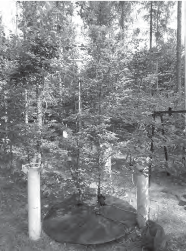
Abbildung 5: WKL mit Abdeckhaube zur Ermittlung der Trockenstresswirkung auf das Wachstum junger Buchen.
