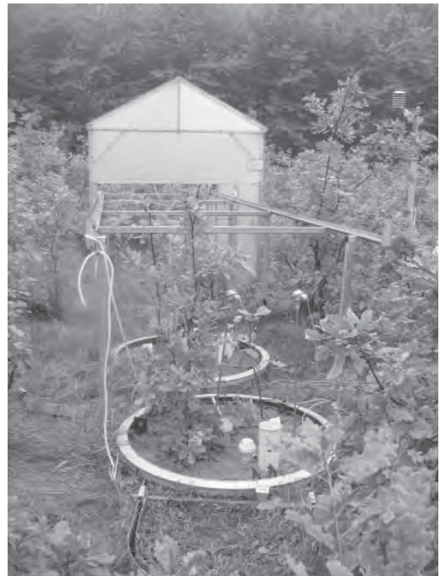
Abbildung 4: WKL mit fahrbarem Dach zur Ermittlung des Wasserverbrauches kleiner Eichen.
