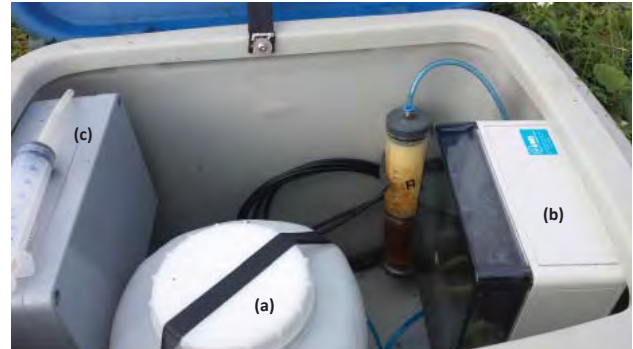
Abbildung 3: Feldbox mit Vorratswasserbehälter (a), Pumpen (b), Pumpensteuerung (c) sowie Ionentauscherkartusche (d).
