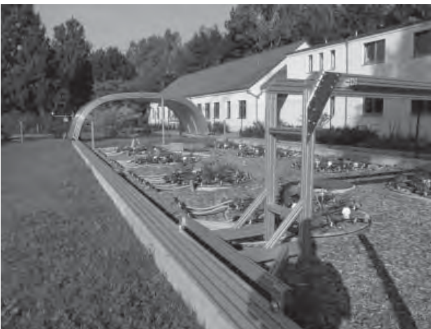
Abbildung 7: Drylab mit acht Lysimetern, fahrbarem Dach und installierter Tropfenbewässerung.
