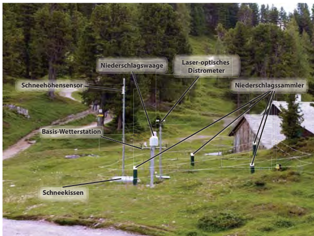
Abbildung 2: Technische Ausstattung der Wetterstation am Standort Stoderzinken.
