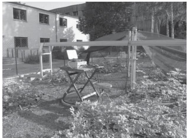
Abbildung 8: Drylab mit Wurzelbrücke und Wurzelkamera zur Erfassung der Feinwurzeldynamik im Boden.
