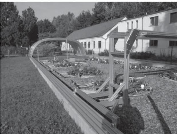
Abbildung 7: Drylab mit acht Lysimetern, fahrbarem Dach und installierter Tropfenbewässerung.
