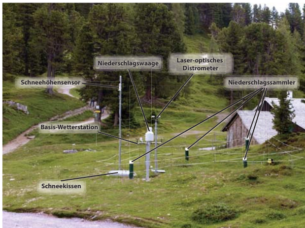
Abbildung 2: Technische Ausstattung der Wetterstation am Standort Stoderzinken.
