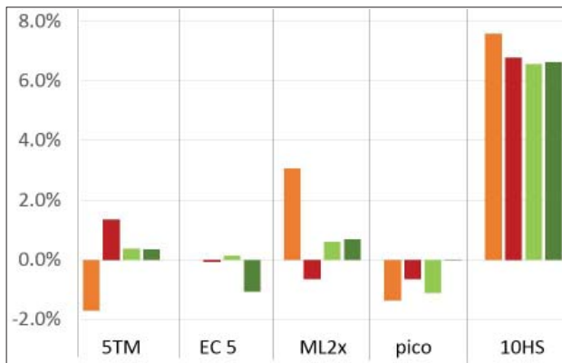
Abbildung 6: Offsets der Wassergehaltssensoren gegenüber den Ensemblemeans. Positive Abweichung bedeutet, dass der Sensor höhere Werte anzeigt als das Ensemble. Die Farben kennzeichnen die Brache (braun) und Weizen(grün) in den Tiefen 12,5 cm (hell) und 25 cm (dunkel).
