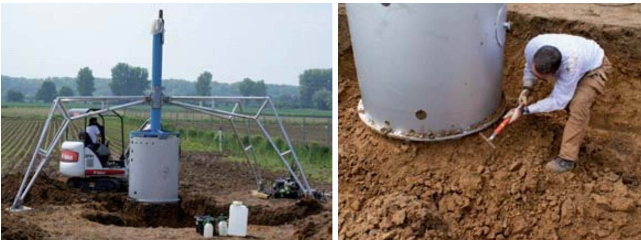
Abbildung 4: Lysimeter mit aufgesetztem Druckstempel (links) und manuelle Nachbearbeitung im Bereich der Lysimeterschneider (rechts).
