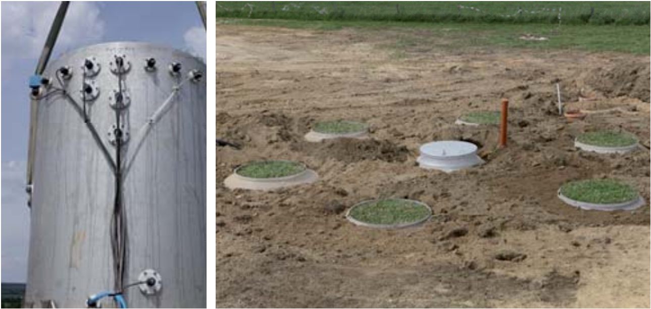
Abbildung 6: Komplett instrumentiertes Lysimeter (links), Lysimeteranlage in Rollesbroich (Observatorium Eifel/Niederrheinische Bucht) kurz vor der Fertigstellung (rechts).
