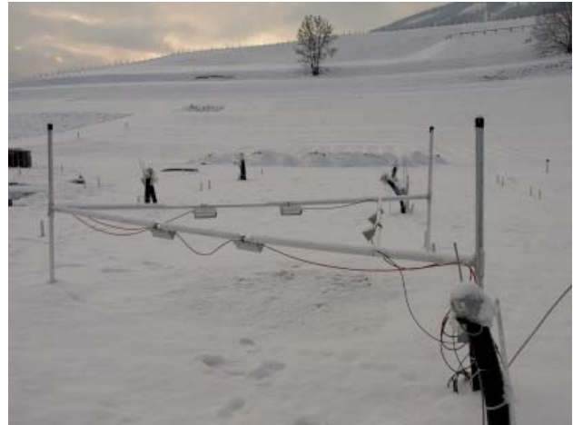
Abbildung 2b: Anordnung der Infrarotstrahler auf einem höhenverstellbaren Alugestänge im Versuchsgelände des technischen Versuchskonzeptes „Lysi-T-FACE“
