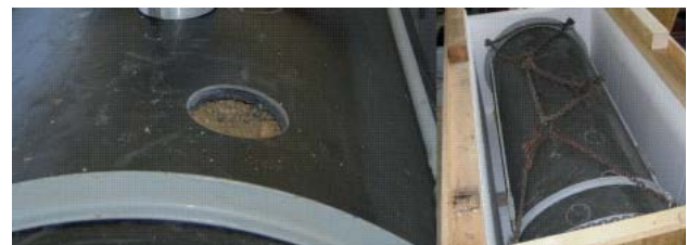
Abbildung 2: Tiefgefrorener Zylinder mit Einbaulöchern
