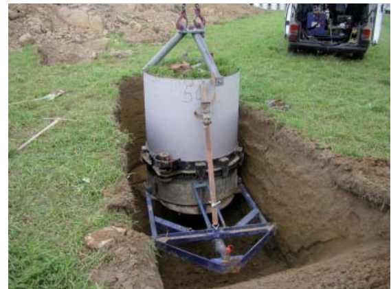
Abbildung 2: Abschervorrichtung für Bodenmonolithe.
