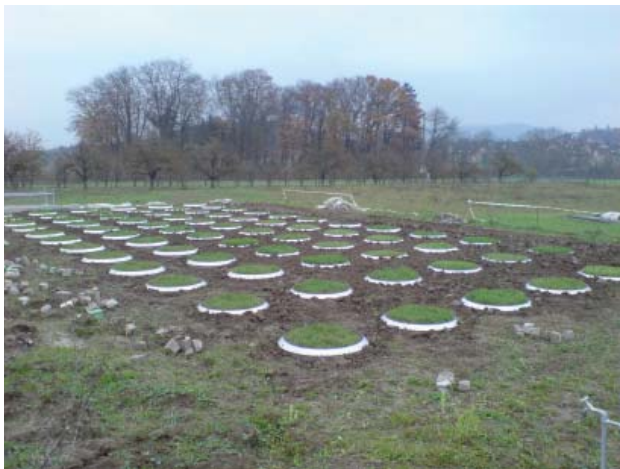
Abbildung 8: Blick auf die 72 Lysimeter nach Montage der Lysimeterkragen.
