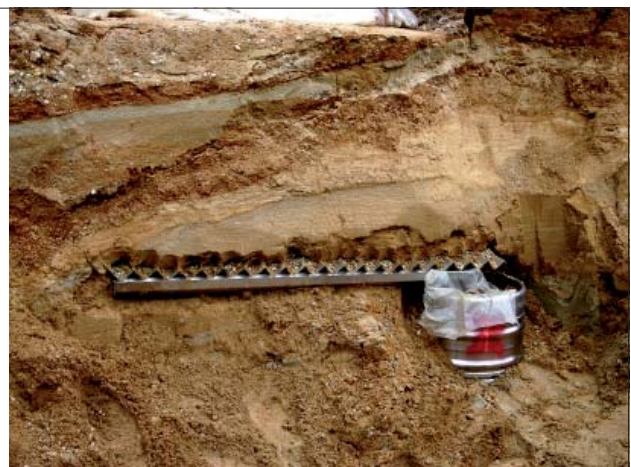
Abbildung 1: Links: Skizze der Auffangbleche für die Rillenlysimeter. Von diesen Auffangblechen wurden 18 Stück pro Lysimeter verwendet, so dass sich eine Auffangfläche von ca. 1,25 x 1,25 m ergab. Durch das modulare System konnten diese Lysimeter großflächig eingebaut werden ohne den darüber liegenden Boden zu entfernen. Rechts: Fertig eingebautes Rillenlysimeter im ungestörten Boden.
