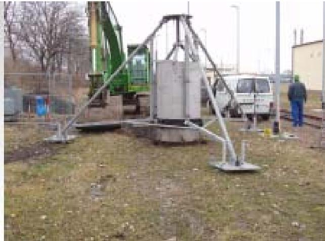
Abbildung 3: Entnahme der Lysimeterkerne
