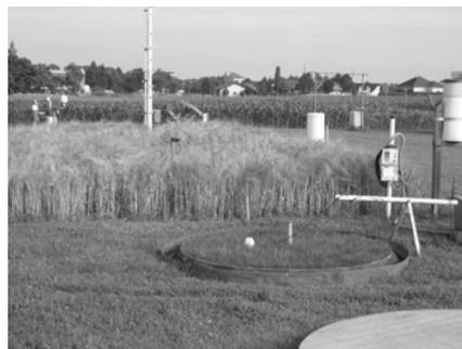
Abbildung 1: Wägbare Lysimeteranlage Groß-Enzersdorf mit agrarmeteorologischer Station
