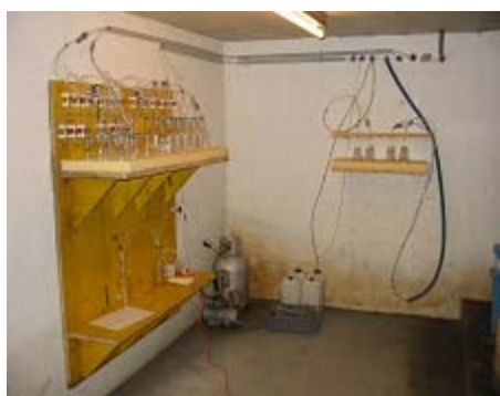
Abbildung 3: Schematische Darstellung der Sickerwassergewinnung (links) sowie Auffangbehälter und Vakuumpumpe (rechts)
