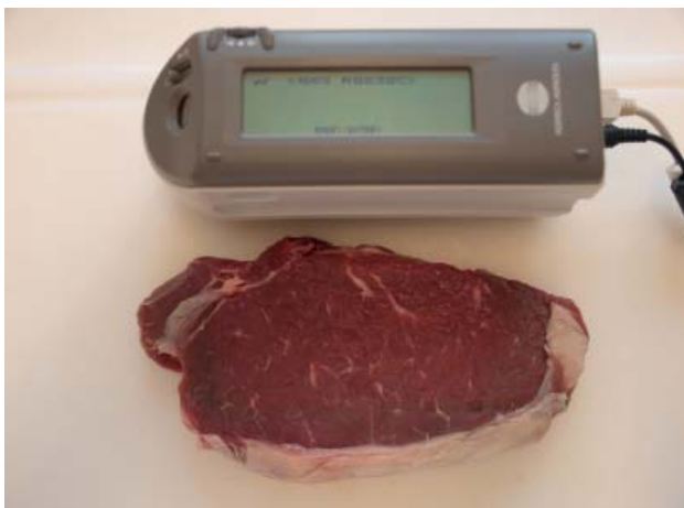
Abbildung 5: Farbmessung mit Spectrometer (Konica Minolta)
