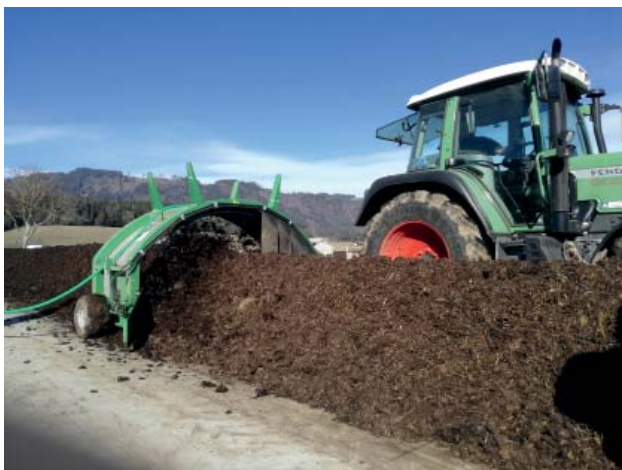
Abbildung 4: Intensive Kompostierung auf technisch dichter Bodenplatte, Kompostwender und Wasserzuteilung. Bild: Angeringer
