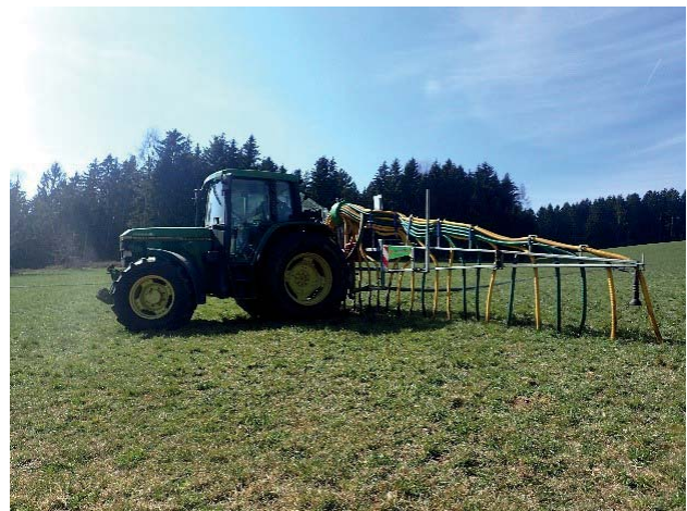
Abbildung 7: Gülleverschlauchung mit bodennaher Ausbringung mittels Schleppschauch. Bild: Angeringer
