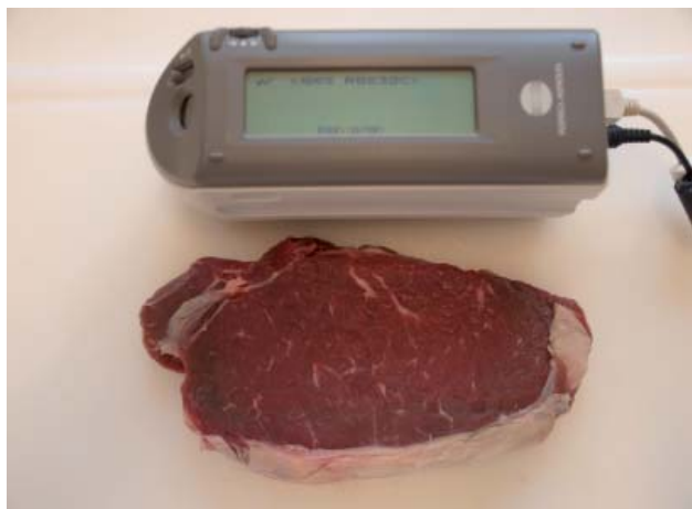
Abbildung 5: Farbmessung mit Spectrometer (Konica Minolta)
