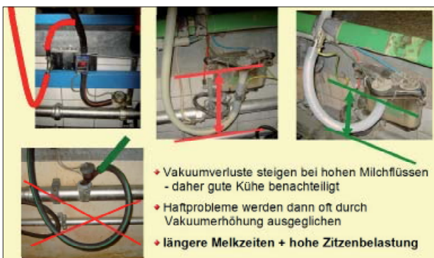
Abbildung 9: Schlauchführung unter Melkkante ungünstig
