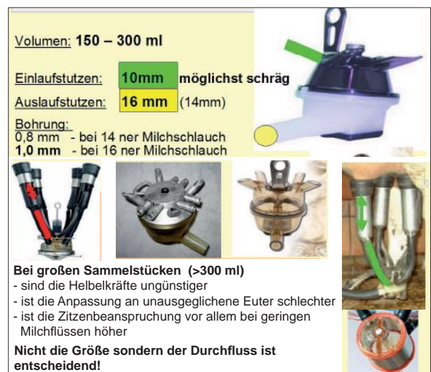
Abbildung 15: Melkzeug an Euter und Milchflüsse anpassen!
