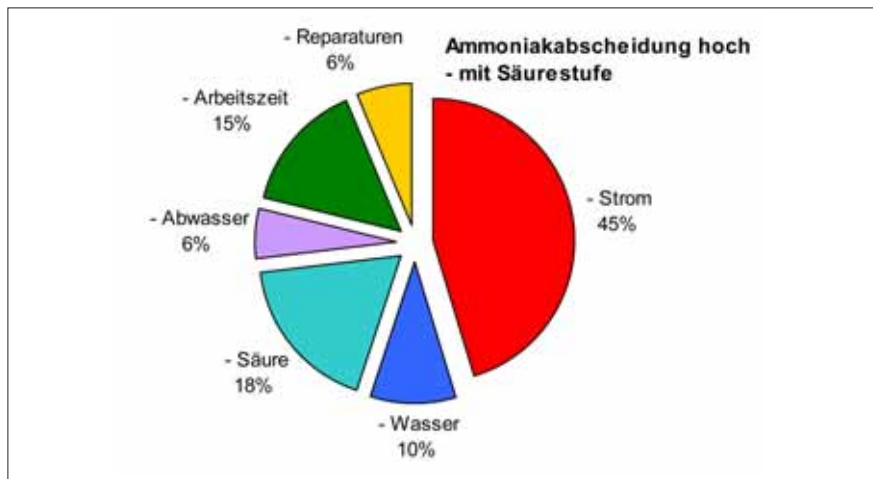
Abbildung 7: Beispielhafte Zusammensetzung der Betriebskosten für Anlagen mit hoher Ammoniakabscheidung (Anlagen mit Säurestufe, Wirkungsgrad \geq 90\% )
