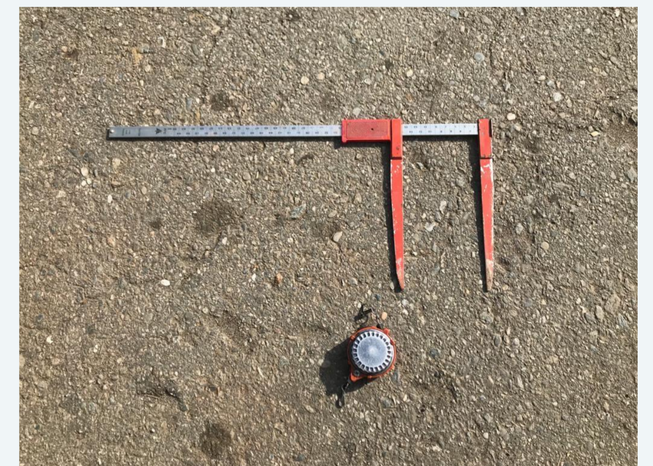
Abb.2: Forstmaßband, Messkluppe (Zwillink, 2020)
