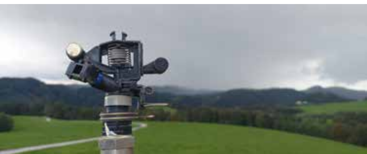
Am Ende der Verteilerlanze befindet sich der Regner Foto: A. Pöllinger-Zierler
