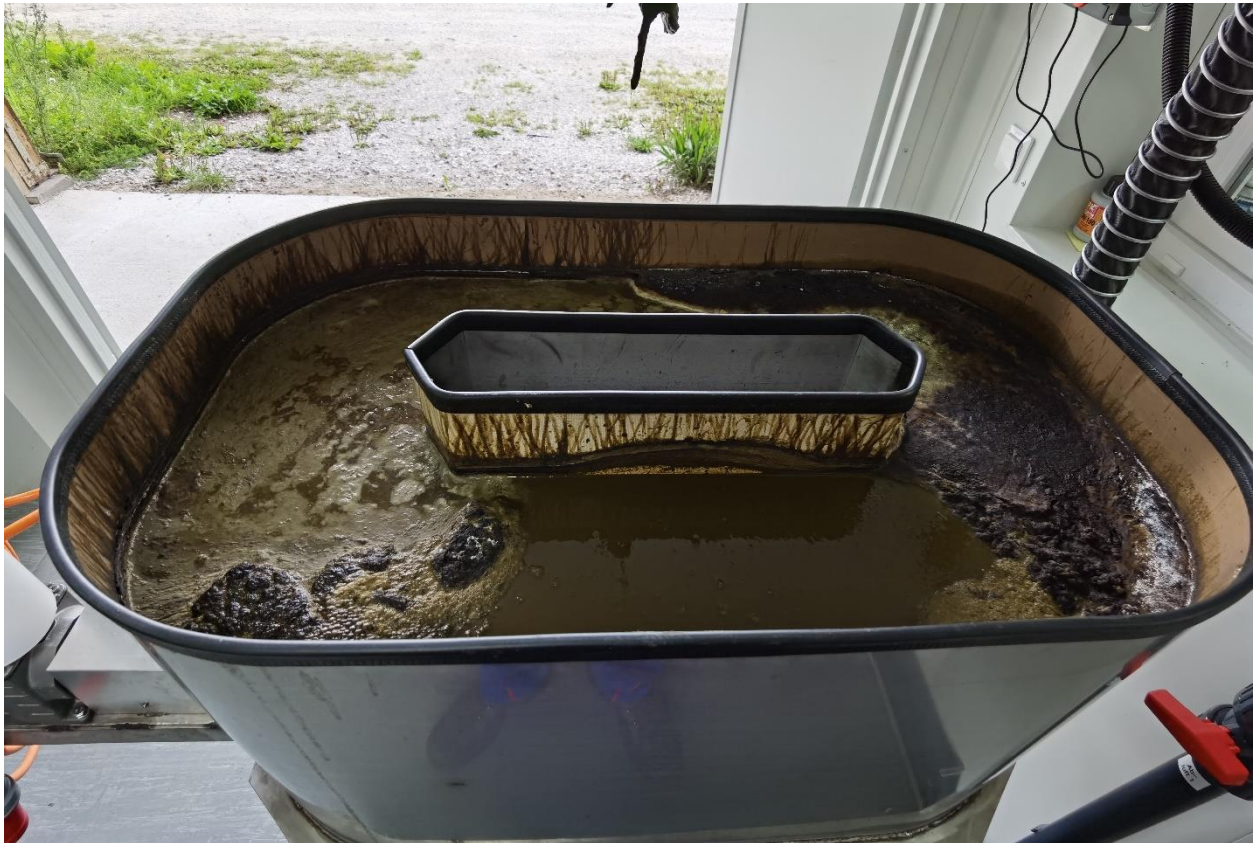
Abbildung 14: Güllebehälter mit aufgebrochener Schwimmdecke- Variante: Rohgülle mit Gipsmehl (HBLFA Raumberg-Gumpenstein, 2021)
