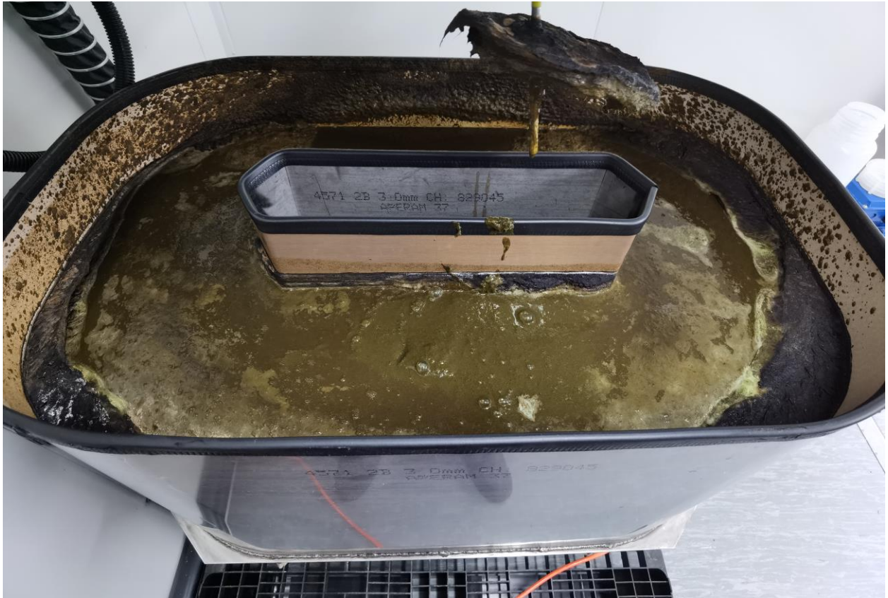
Abbildung 15: Güllebehälter mit aufgebrochener Schwimmdecke welche etwas fester und stärker ausgeführt ist- Variante: Rohgülle (HBLFA Raumberg-Gumpenstein, 2021)
