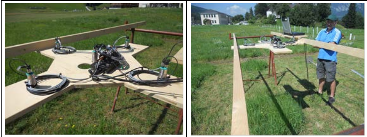
Abbildung 9: Prototyp der Messplatte mit 5 synchronisierten Ultraschallsensoren und der Öffnung für die Fotodokumentation mittels Digitaler Weitwinkelkamera
