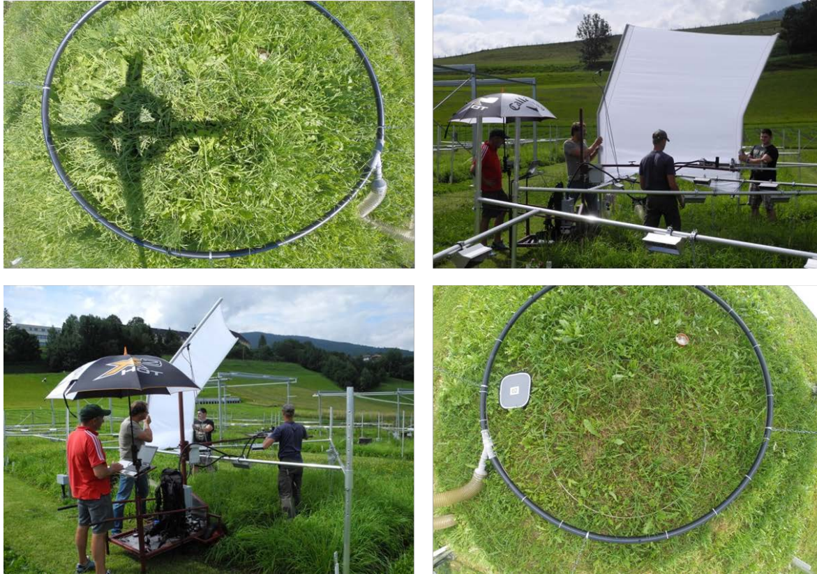
Abbildung 7: Erzeugung eines diffusen Schattens während der Messungen von Spektren am Grünland
