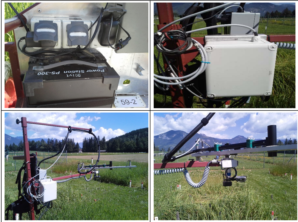
Abbildung 16: Stromversorgung und Schnittstelle für USB (oben) und Messleiste im Einsatz (unten)
