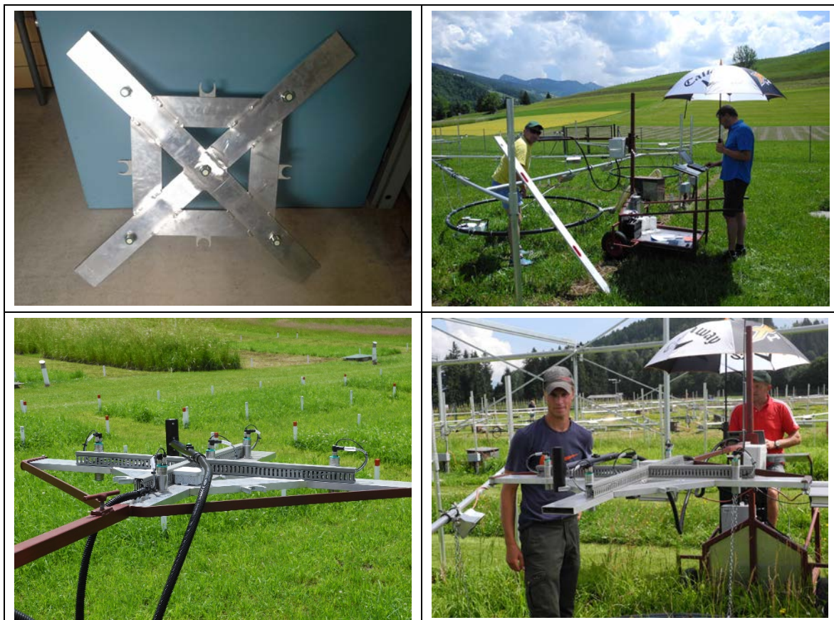
Abbildung 11: Messplatte aus Aluminium mit fix montierten Ultraschallsensoren und den Positionen für die Aufnahme des Sensorkopfes des Feldspektrometers
