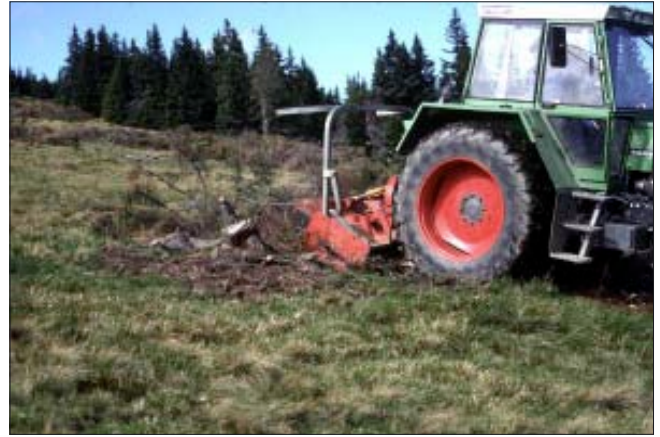
Bild 32: Fräse im Einsatz, das Holzmaterial wird zerkleinert und in die obere Bodenschicht eingearbeitet
