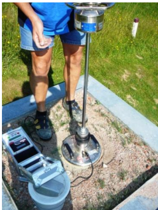
Abbildung 26: Durchführung des dynamischen Lastplattenversuchs an der Versuchsfläche 1 - Schwerkraftlysimeter
