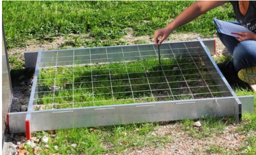
Abbildung 49: Aluminiumrahmen für die Durchführung der Frequenzanalyse
