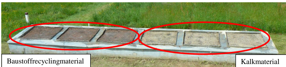
Abbildung 15: Vollständiger Einbau der Schwerkraftlysimeter
