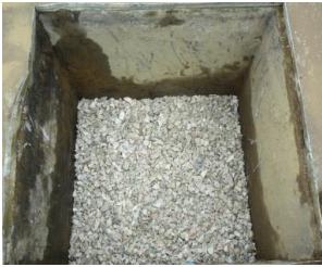
Abbildung 11: Befüllen der Lysimeter mit 16/32 Schotter
