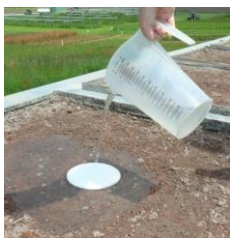
Abbildung 23: Ausschüttversuch an der Versuchsfläche 1 – Schwerkraftlysimeter nach RVS 11.06.29 (2004)
