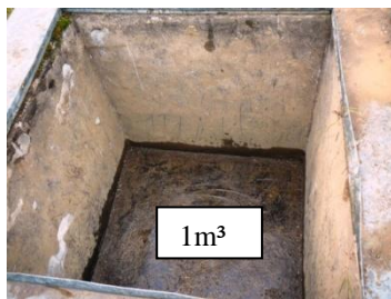
Abbildung 9: Schwerkraftlysimeter in Gumpenstein
