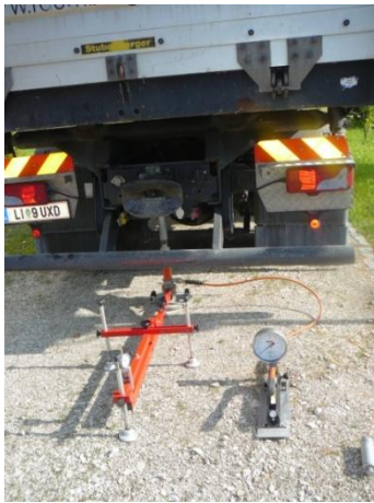
Abbildung 27: Durchführung des statischen Lastplattenversuchs an der Versuchsfläche 2 – Zufahrtsstraße
