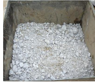
Abbildung 12: Befüllen der Lysimeter mit 0/70 Schotter
