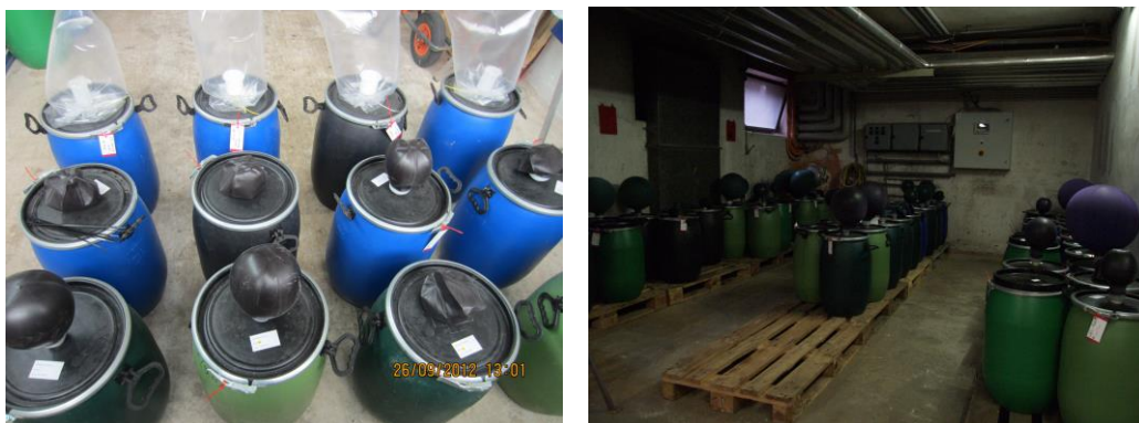
Abbildung 2: Anlieferung von Laborsilos mit Gassack bzw. Gasballon und Lagerung im Pflanzenbaugebäude-Keller des LFZ Raumberg-Gumpenstein
