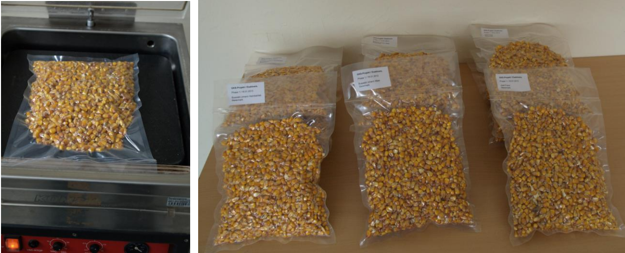
Abbildung 4: Vakuumierung und Probenkennzeichnung der GKS-Proben
