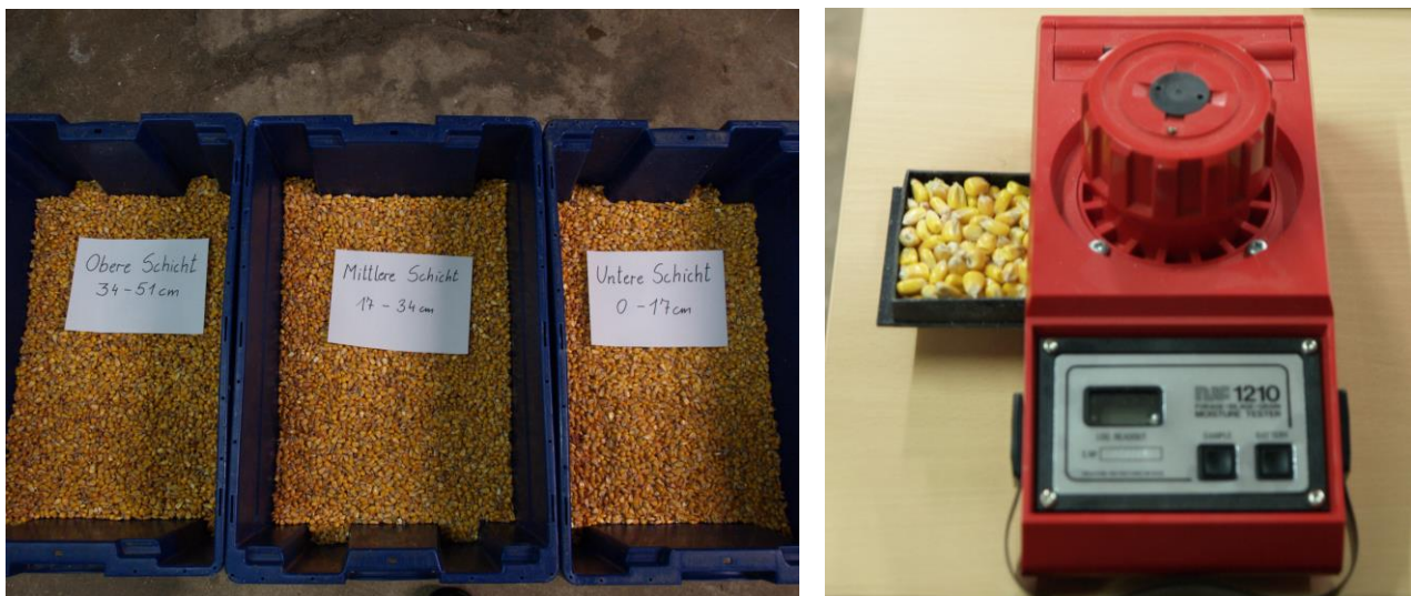
Abbildung 3: Schichtweise Aufteilung des Probenmaterials und TM-Schnellmessung im Silierversuch S-61
