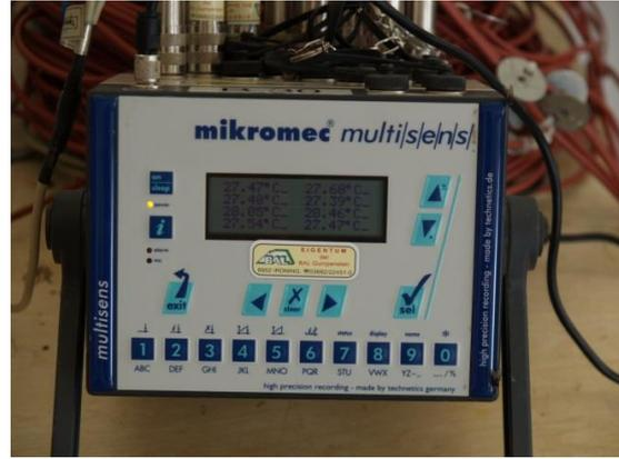
Abbildung 4: Haltbarkeitstest und Temperaturaufzeichnung mit Datenlogger Mikromec Multisens (Silierversuch S-68)
