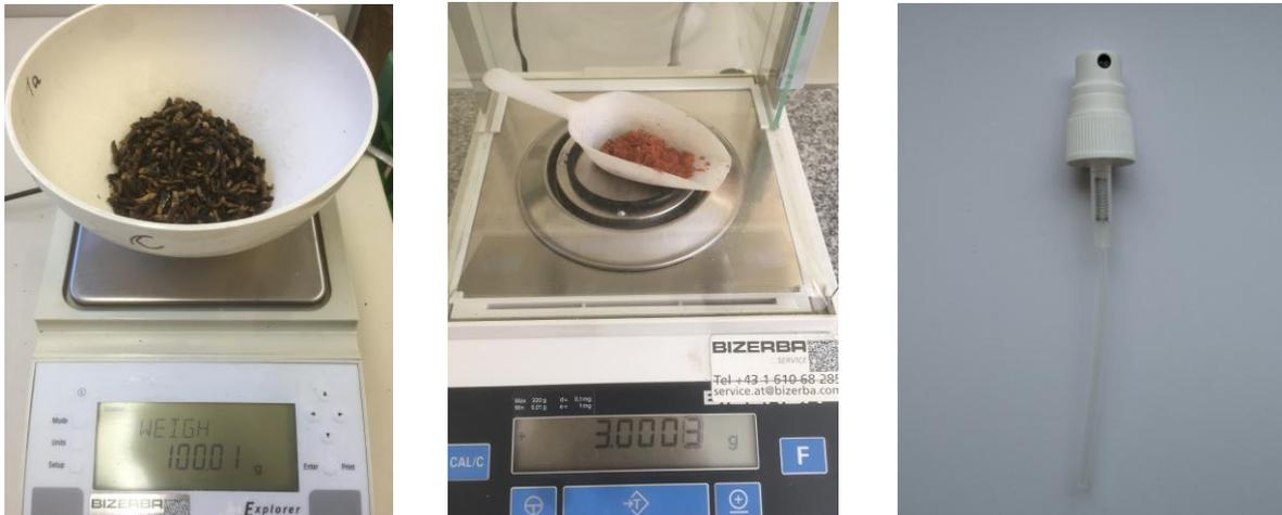
Abbildung 1: Einwaage von Larven (links) und Tannin (Mitte) sowie Flüssigkeitsdosierpumpe mit Zerstäuber (rechts) für Silierversuch S-68
