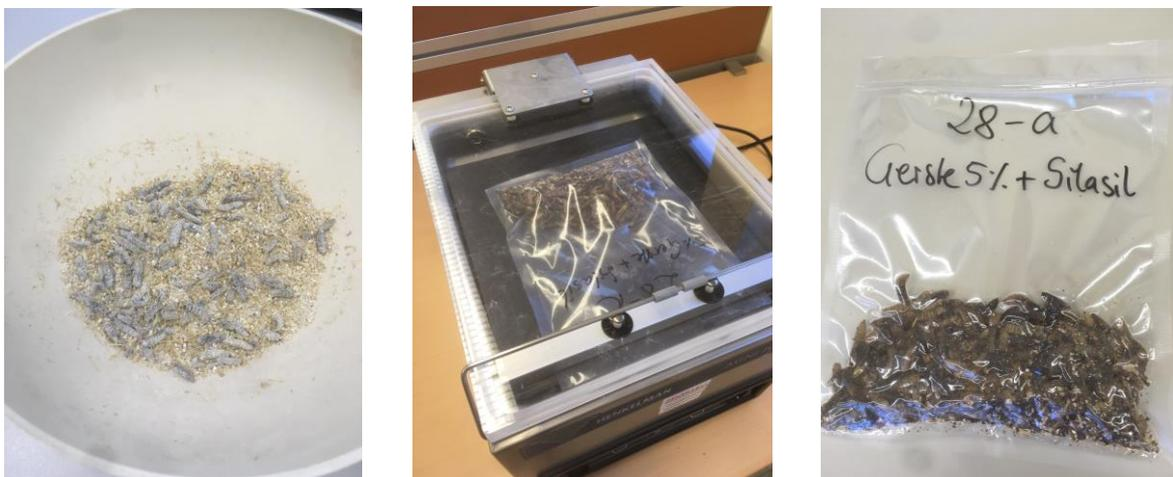
Abbildung 2: Gerstenzumischung (links), Vakuumierungstechnik (Mitte) und fertig verschweißter Vakuumbbeutel
